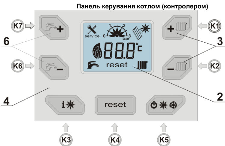
Мал.2.2.1.2. Розташування вузлів у однофункційному котлі ECOCONDENS CRYSTAL II PLUS
